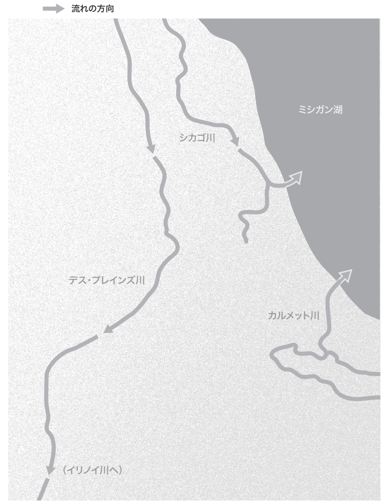
流れを逆転させる前のシカゴ川はミシガン湖に流れこんでいた。
